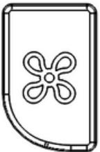
Fan ikonu bulunan tuşa basmanız halinde eğer ısıtma aktif ise ısıtıcı ısıtma kademesini değiştirecektir. Maksimum, orta ve ekonomik ısıtma olarak ayar yapabilirsiniz.
