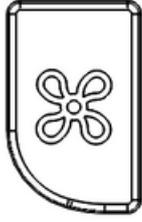
Fan ikonu bulunan tuşa basmanız halinde eğer fan aktif ise ısıtıcı fan kademesini değiştirecektir. Maksimum, orta ve minimum hız olarak ayar yapabilirsiniz.
