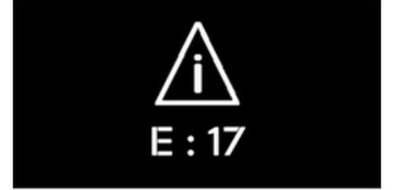
**Hata gösterimi E 17 ise haberleşme problemi var demektir. Sorunu çözmek için ısıtıcının enerjisi kesilip tekrar verilmelidir. Düğmeden resetleme yapılamaz.**
